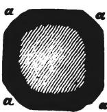
Seiten a a nennt man Wahn- oder Waldkanten. Der Zweck des Bewaldrechtes ist, den unbrauchbaren Splint des Holzes zu entfernen und sehr schwere Stämme für den Transport zu erleichtern. Für die spätere Zurichtung der Holzer ist diese Arbeit unnütz, da sie nicht mit der gehörigen Genauigkeit vorgenommen wird, so daß auch schon bewaldrechte Seiten dennoch beschlagen werden müssen. Das Bewaldrechten ist daher nur für sehr
