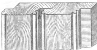
halben Bretterstärke gleich ist. Nicht immer werden beide ineinandergreifenden Falze gleich lang, sondern der eine länger als der andere gemacht, wodurch die Fuge offen bleibt. Gewöhnlich beabsichtigt man dann durch diese in gleichen und parallel neben einander hinlaufenden Fugen die Decoration einer Fläche und richtet dann den Falz auch wohl so ein, wie ihn Fig. 45 bei a zeigt.
